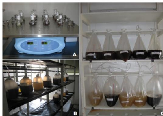
Fig. 3 – Proceso de masificación de las cepas de interés: 50 ml (A), 2 litros (B) y 15 litros (C)
